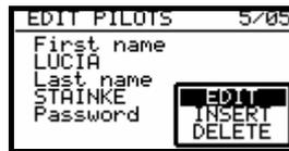
La fonction de **Insert** permet entrée d'autres pilotes (30 participants max.). Une communication « active » (en haut à droite) informe que les réglages spécifiques des pilotes sont actifs (c.-à-d. choisi après la mise sous tension).
