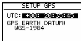
La date de GPS Earth ne peut pas être ajusté, puisque le FAI régulateur n'accepte que WGS-1984.
