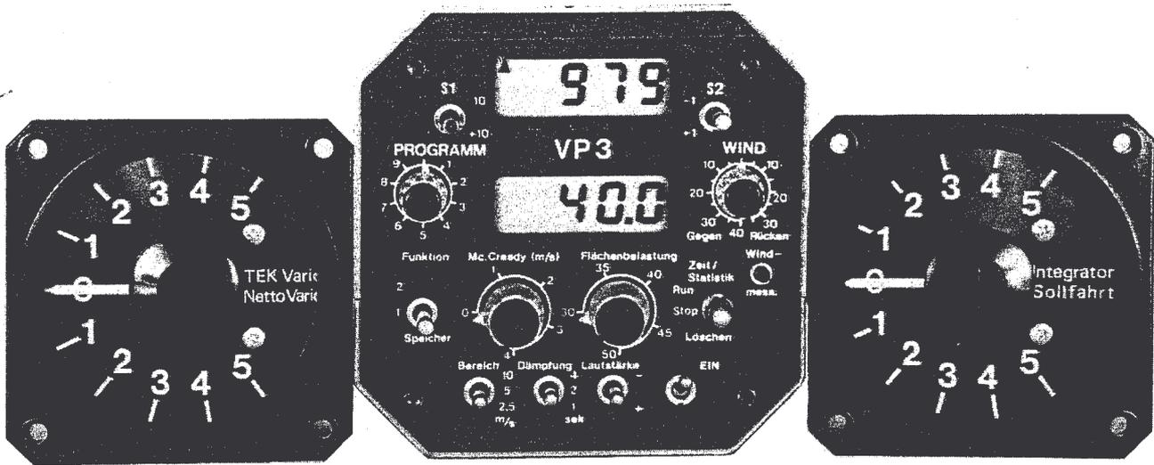
**VARIOMÈTRE À SONDES DE PRESSION COMPENSÉ ÉLECTRONIQUEMENT
