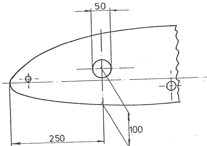
**Position et dimensions des ouvertures de contrôle dans nervure d'emplanture (gauche et droite)**
